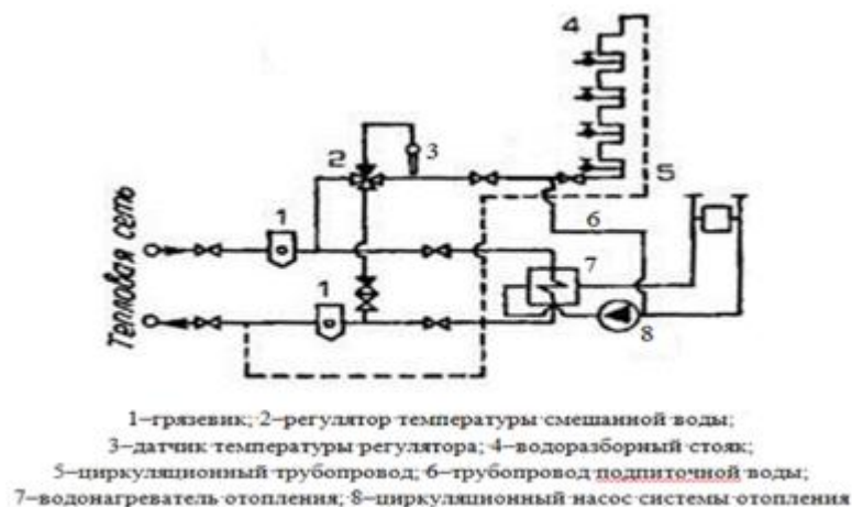
Рисунок 36 – Непосредственное присоединение системы горячего водоснабжения к подающему и обратному трубопроводам при независимом присоединении систем отопления
