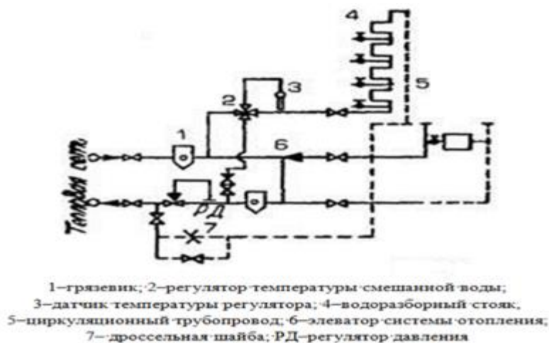
Рисунок 35 – Непосредственное присоединение системы горячего водоснабжения к подающему и обратному трубопроводам
